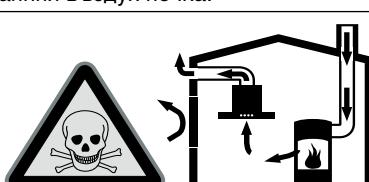
Зависимите от стайнния въздух печки (напр. нагревателните уреди, работещи с газ, нафта, дърво или въглища, конвекторните нагреватели, калориферите) изтеглят въздух за изгаряне от мястото на поставяне и изкарват отработени газове през съоръжение за отработени газове (напр. димоотвод) на открито.
