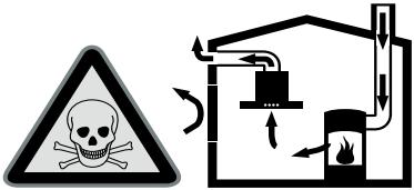
Ildsteder, hvis lufttilførsel sker fra indeluften, (f.eks. gas-, olie-, træ- eller kulfyrede varmeapparater, gennemstrømningsvandvarmere, vandvarmere) henter deres forbrændingsluft fra opstillingsrummet og fører røggassen ud gennem en røggaskanal(f.eks. skorsten) til det fri.
