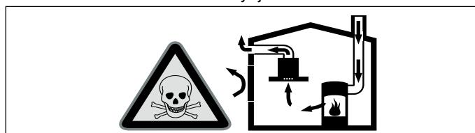
Eldstäder som är beroende av rumsluft (t.ex. värmear apparater som drivas med gas, olja, ved eller kol, genomströmningsapparater, varmvattenberedare) tar sin förbränningsslut ur det utrymme där enheten är installerad och leder ut avgaserna i det fria via en avgasanläggning (t.ex. skorsten).
