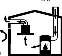
Ildsteder som er avhengig av romluft (f.eks. varmeapparater som drives med gass, olje eller kull, varmtvannsbereedere) bruker forbrenningsluften fra oppställingsrommet og leder avgassene gjennom et avgassanlegg (f.eks. pipe) i det fri.
