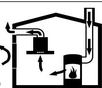
Locurile de gătit influențabile de aerul camerei (de ex. aparate de încălzit cu gaz, ulei, lemn sau cărbune, încălzitoare permanente, preparatoare de apă caldă) absorb aerul de ardere din spațiul în care sunt instalate și evacuează gazele arse în afară printr-o instalație de evacuare a gazelor (de ex. coș de fum).
