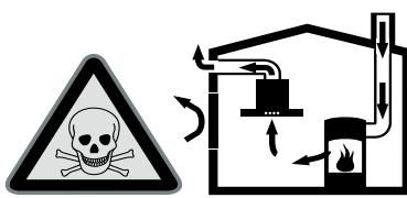
I focolari che dipendono dall'aria ambiente (peres. a gas, olio, legna o carbone, scaldabagno, caldaie elettriche) ricavano l'aria per la combustione dalla stanza ed eliminano i gas di scarico all'esterno attraverso un impianto (peres. camino).
