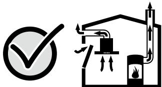
Raadpleeg in ieder geval het bedrijf dat in uw huis zorgt voor de schoorsteenreiniging. Dit bedrijf is in staat het totale ventilatiesysteem van uw huis te beoordelen en kan een voorstel doen voor passende maatregelen op het gebied van de luchtoevoer.
