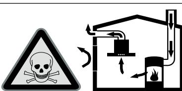
Huoneilmaa tarvitsevat tulisijat (esim. kaasu-, öljy-, puu- tai hiilikäytöiset lämmityslaitteet, läpivirtauskuumennin, vedenkuumennin) ottavat poltoilman huonetilasta ja johtavat poistoilman poistoilmalaitteen (esim. savutorven) kautta ulos. Tuuletin imkeelee keittiöstä ja sen viereisistä huoneista ilmaa - tämä on korvattava riittävällä tuloilmallla - muutoin syntyyn alipaine. Myrkylliset kaasut imetyisivät takaisin huoneisiin savutorvesta tai poistoilmakanavasta.
